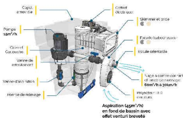
Elle limite également le gaspillage d'eau grâce à son fonctionnement en circuit fermé ne nécessitant pas de backwash.
